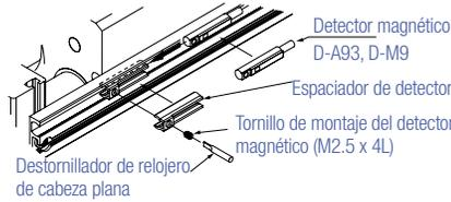
Detector magnético aplicable/Montaje sobre rail
